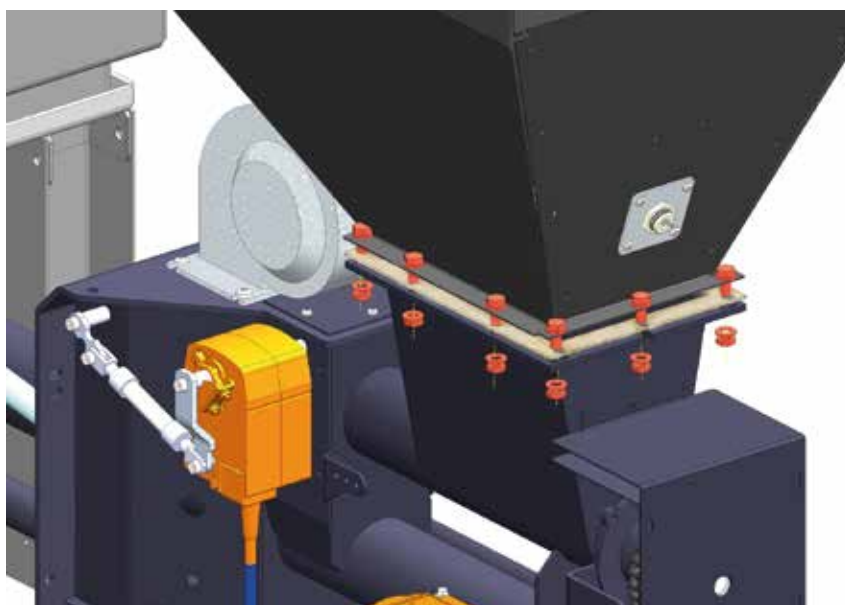
Fissaggio del serbatoio alla flangia del bruciatore.
