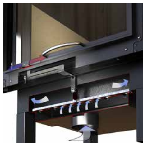
Sistema di gestione e regolazione dell'aria di combustione
