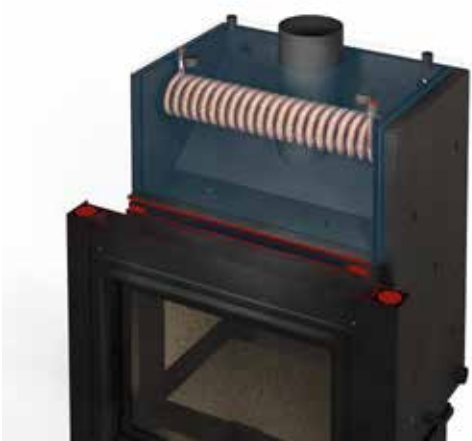
2) Scambiatore EASY LINK tipo S1 per produzione integrata ACS ed impianto a vaso aperto oppure per scarico termico e impianto a vaso chiuso
