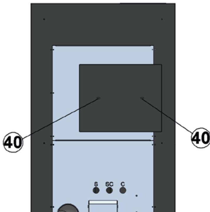
**40** – viti di fissaggio carter di protezione della SmartBox
