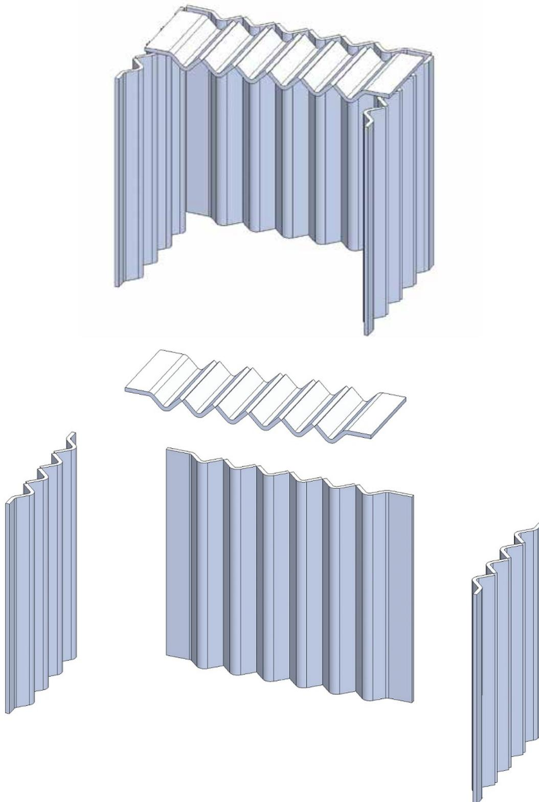
**N.B.: verificare sempre ed in ogni caso che gli elementi in acciaio inox della camera di combustione si trovino correttamente inseriti nella posizione in alto illustrata.**
