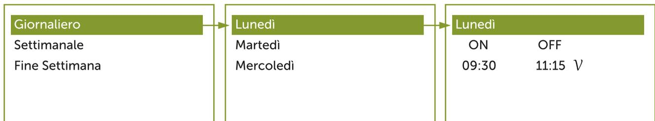
**Programmazione a cavallo di mezzanotte:** impostare per una fascia di programmazione di un giorno l'orario di OFF sulle 23:59 e impostare per una fascia di programmazione del giorno successivo l'orario di ON sulle 00:00.
