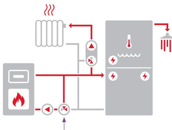
4. La caldaia deve obbligatoriamente essere collegata ad un serbatoio di accumulo inerziale la cui capacità deve essere calcolata secondo le disposizioni della EN 303-5/2013 e **comunque mai inferiore al rapporto 50 lt. /kW di potenza.**
