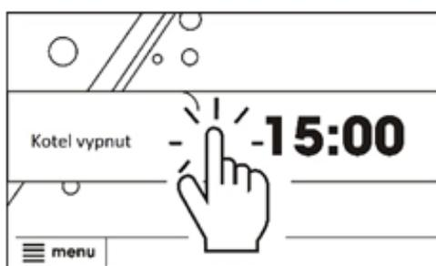
su qualsiasi punto dello schermo e selezionando: **Attivare il Termoregolatore** → **Si**, il termoregolatore si avvia. In tal modo si attiva la parte idraulica dell'impianto (pompe, MIXER, Puffer, boiler ACS) la quale funziona in base ai parametri impostati, la caldaia è nella modalità **STOP**.
