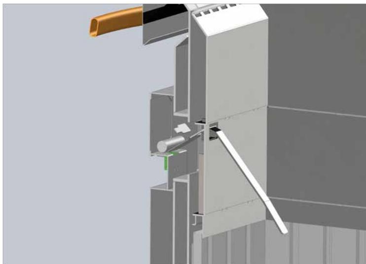
Ad ogni apertura del portello di caricamento un leveraggio meccanico provvede a posizionare il sistema di rilevamento in posizione di riposo, tale da consentire il caricamento del combustibile senza che esso possa accidentalmente bloccare/ostruire la corsa e pregiudicarne il corretto funzionamento.
